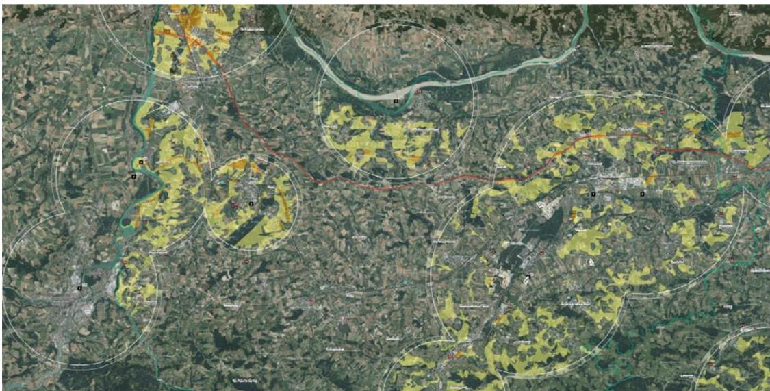
Abbildung 5: Darstellung der Umspannwerke mit differenzierten Radien in Abhängigkeit von den jeweils freien Kapazitäten und einem 300m-„Bonus“-Rand (eigene Darstellung)
