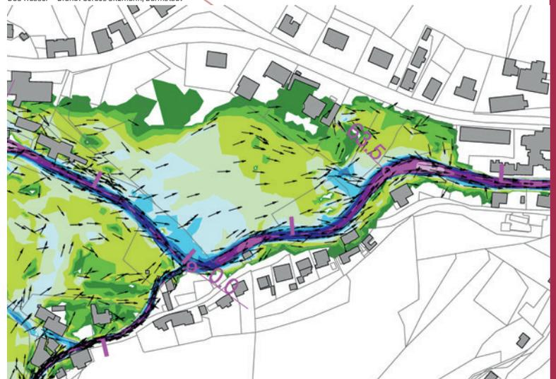
Strömungsgeschwindigkeiten bei HQ100
